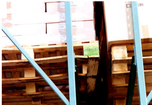
Afbeelding 1 Voorbeeld van een 1200 mm diepe pallet die niet geschikt is om in een 900 mm diep juk te worden afgezet
